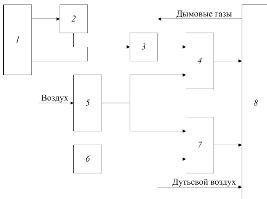
Рисунок 1. – Принципиальная схема факельного сжигания ВУТ: 1 – емкость для ВУТ, 2-3 – насосы, 4 – форсунка на водоугольном топливе, 5 – компрессор, 6 – емкость для дизельного топлива, 7 – инициализирующая горелка на дизельном топливе, 8 – топка
